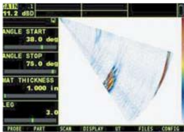
Representación de indicaciones en imágenes de barrido sectorial
