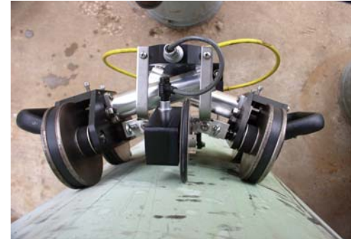
La araña UT tiene ruedas magnéticas muy potentes
